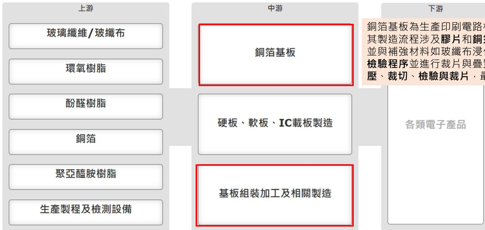
銅箔基板為生產印刷電路板之關鍵核心基礎材料，其製造流程涉及膠片和銅箔在高溫高壓下的層疊，並與補強材料如玻纖布浸化成膠片；之後經過膠片檢驗程序並進行裁片與疊置，再覆加銅箔，經過熱壓、裁切、檢驗與裁片，最終製成銅箔基板。
